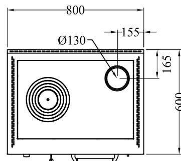
Versione con uscita fumi a destra. La versione con uscita fumi a sinistra è simmetrica.
